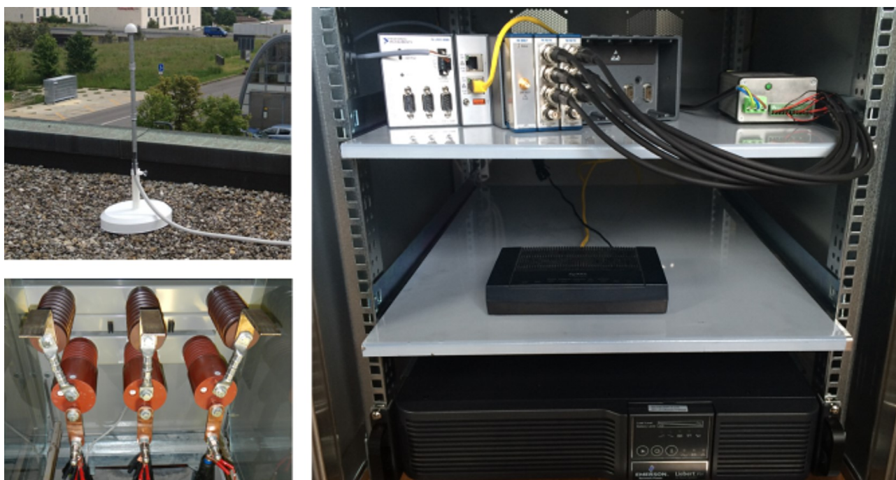
Figura 4.2: alcune componenti della smart-grid del campus EPFL. In alto a sinistra un'antenna GPS, in basso a sinistra i trasduttori di corrente e tensione Altea CVS-24; a destra, dal basso verso l'alto, una PMU, il modem per la trasmissione dati e l'UPS. [17]
